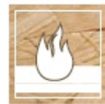
Klasyfikacja ogniowa: D-s2, d0 (EN 13501-1) Fire classifier: D-s2, d0 (EN 13501-1)
